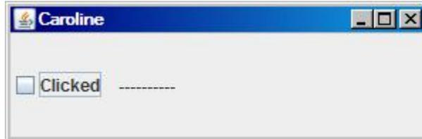
Weil `JFrame` eine *Behälterklasse* ist, ist auch jedes `Miez`-Objekt ein *Behälter* (engl. a container object). Der folgende schematische Bauplan soll deutlich machen, dass ein `Miez`-Objekt drei weitere Grabo-Objekte enthält: Ein `JCheckBox`-Objekt, ein `JLabel`-Objekt und ein horizontales `Box`-Objekt:
