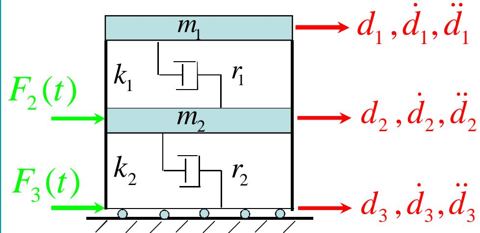
$$\begin{bmatrix} m_1 & \begin{bmatrix} \ddot{d}_1 \\ \ddot{d}_2 \\ \ddot{d}_3 \end{bmatrix} + \begin{bmatrix} r_1 & -r_1 & \\ -r_1 & r_1 + r_2 & -r_2 \\ & -r_2 & r_2 \end{bmatrix} \begin{bmatrix} \dot{d}_1 \\ \dot{d}_2 \\ \dot{d}_3 \end{bmatrix} + \begin{bmatrix} k_1 & -k_1 & \\ -k_1 & k_1 + k_2 & -k_2 \\ & -k_2 & k_2 \end{bmatrix} \begin{bmatrix} d_1 \\ d_2 \\ d_3 \end{bmatrix} = \begin{bmatrix} 0 \\ F_2(t) \\ F_3(t) \end{bmatrix}$$
