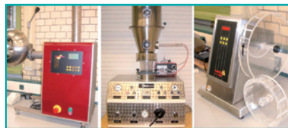
Herstellung und Prüfgeräte (von links): Dragee-Kessel, Wirbelschichtenanlage, Abriebtester
